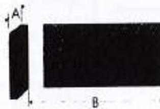
Lorsqu'un auvent et des ailettes verticales sont utilisés simultanément, les facteurs de projection FP pour l'auvent et pour les ailettes doivent être calculés séparément et les coefficients de masque architecturaux Fma<sub>i</sub> correspondants doivent être déterminés d'après les tableaux précédents. Ensuite, on retient le coefficient de masque Fma<sub>i</sub> le plus petit correspondant aux ailettes verticales ou à l'auvent.
